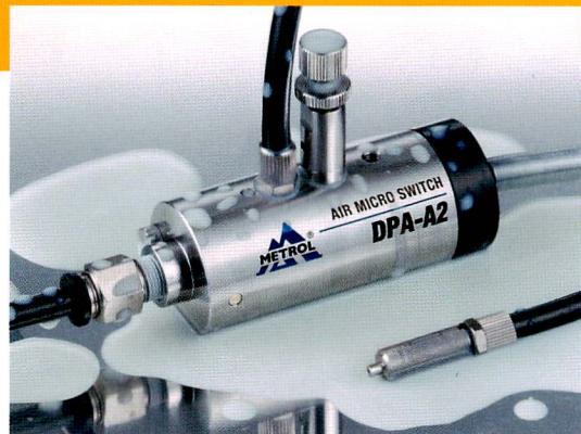
体(制御部)を切削加工現場から離し、機外に設置している。エア着座センサは、空気の給排気箇所が多く、フラッシングによるミストの飛散や、加工中に切りくずやクーラントがかかることで、破損の原因になってしまうからである。
